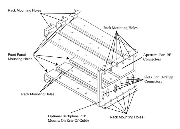
Figure 10 T800-41-0003 Triple Guide
